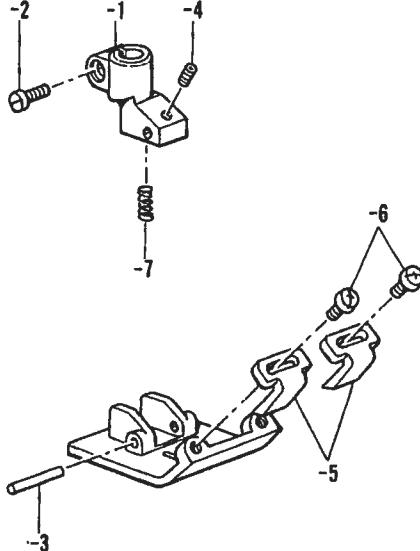
C. 押工関係 / Presser foot mechanism / Stoffdrückerfuß /
