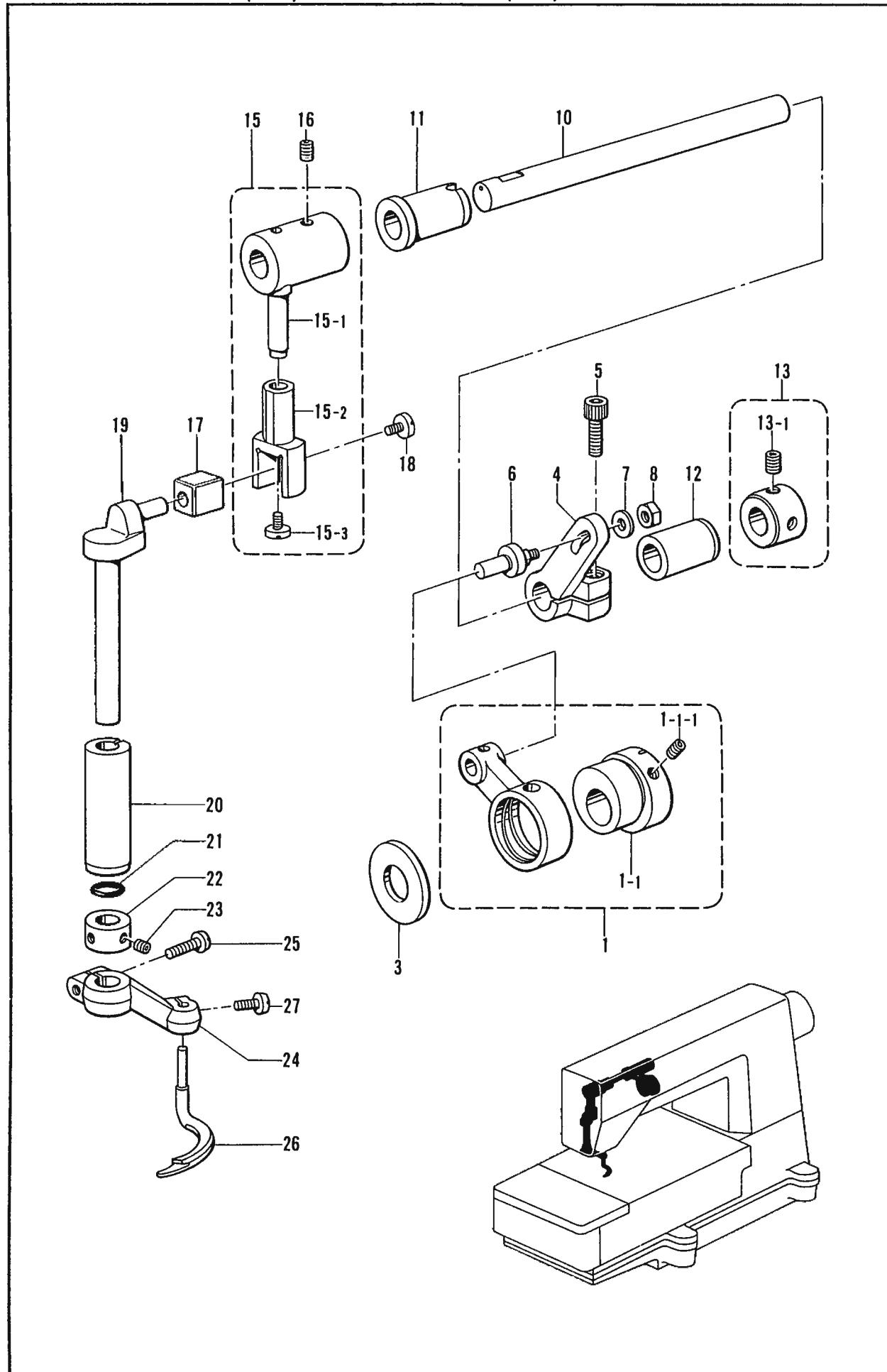
J. スプレーダ関係 (B272) / Spreader mechanism (B272) / Spreizvorrichtung (B272) /
