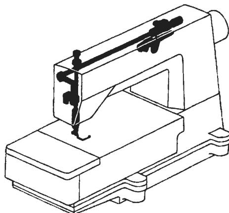
C. 押工関係 / Presser foot mechanism / Stoffdrückerfuß /
